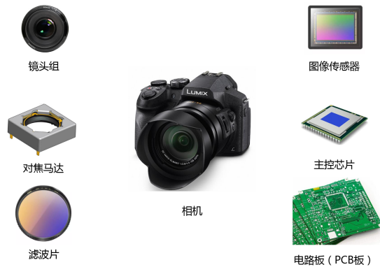
图 3.2: 摄像头组成示意图
