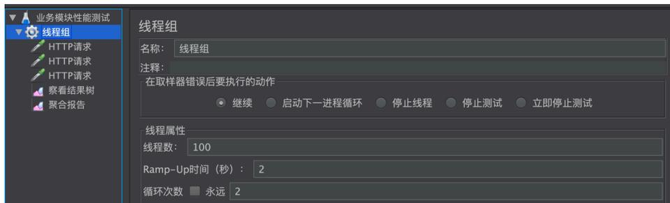
图 5.10: 业务模块性能测试 Jmeter 参数
