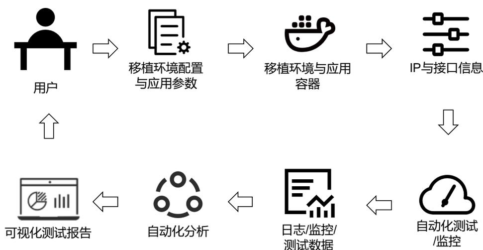
图 3-1: Java Web 应用可移植性自动化测试过程
